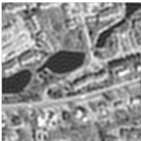
Рисунок 2 – Ограничение спектра для быстрого преобразования Фурье (БПФ)
