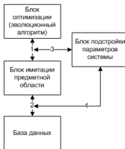
Рисунок 1 – Схема работы системы оптимизации на основе эволюционного алгоритма
