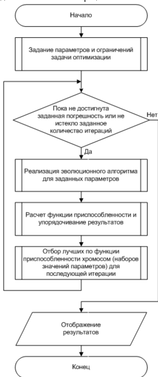
Рисунок 2 – Эволюционный алгоритм решения задачи оптимизации
