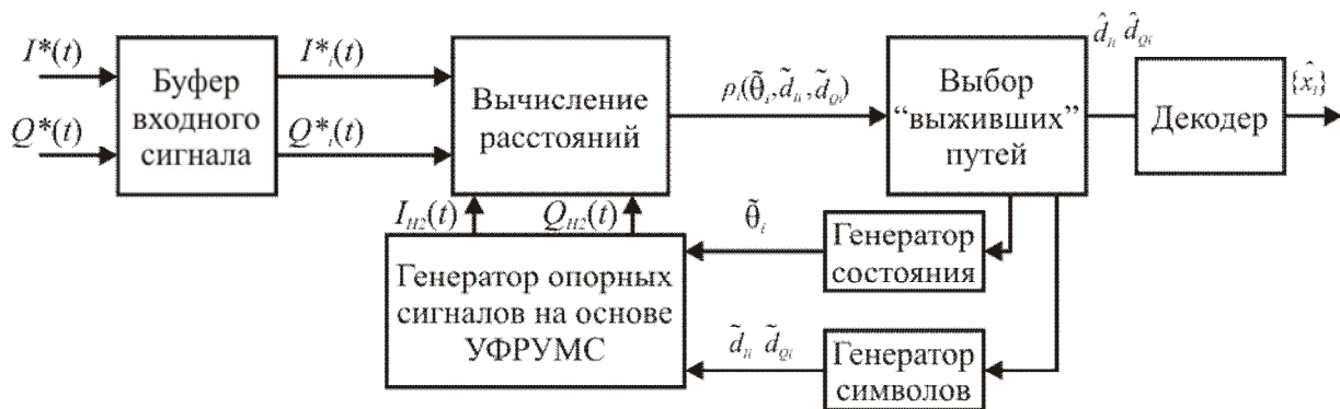
Рисунок 1 – Структура процедуры детектирования сигналов с УСКС
