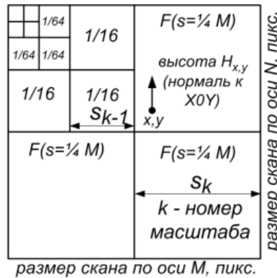
Рисунок 1 – Иллюстрация разбивки изображения поверхности на сегменты различного размера
