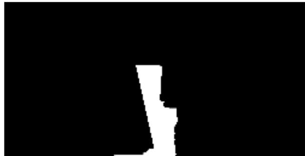
Рисунок 4 – Пример построенной карты проходимости на основе использования рассмотренного алгоритма (белым цветом выделен коридор проходимости, чёрным – непроходимый участок)
