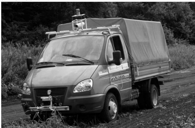
**Рисунок 1 – Автомобиль-робот «ГАЗель БИЗНЕС» СКБ РГРТУ**
