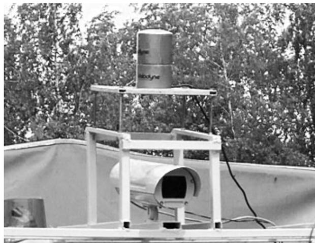
Рисунок 6 – Лидар Velodyne HDL-32E и видеодатчик Beward BD3575, установленные на крыше автомобиля-робота «ГАЗель БИЗНЕС»
