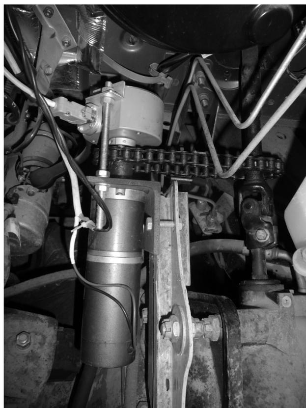
**Рисунок 8 – Устройство управления рулем**
