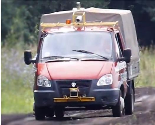
Рисунок 1 – Автомобиль-робот «ГАЗель»
