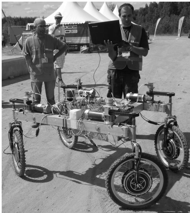
Рисунок 4 – Открытая отладочная робототехническая платформа
