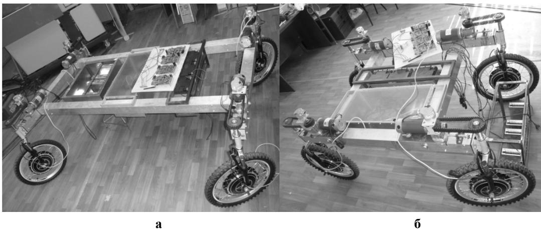
**Рисунок 1 – Ходовая часть робототехнической платформы:**
