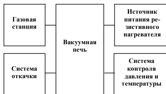
Рисунок 5 – Функциональная схема установки для обработки кремния методом экстракции из твердой фазы
