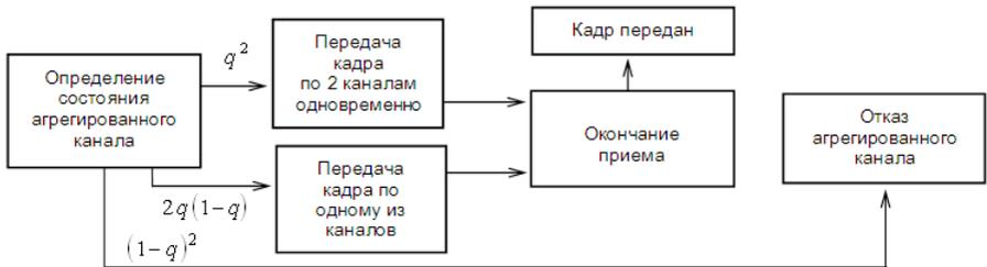
Рис. 2. Блок-схема работы агрегированного канала
