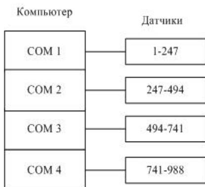
Рисунок 3 – Схема построения АИИС КУЭ для количества датчиков свыше 247 шт. в системе
