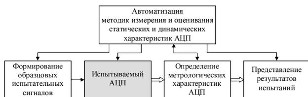
**Рисунок 1 – Структурная схема СПО для аттестации АЦП**
