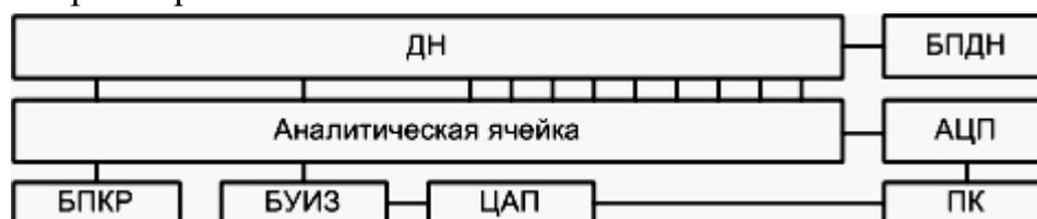
Рисунок 2 – Функциональная схема экспериментального спектрометра ионной подвижности: БПДН – блок питания дрейфового напряжения, ДН – делитель напряжения, АЦП – аналого-цифровой преобразователь, БПКР – блок питания коронного разряда, БУИЗ – блок управления ионным затвором, ЦАП – цифро-аналоговый преобразователь, ПК – компьютер
