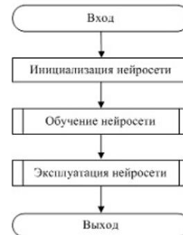
Рисунок 6 – Обобщенный алгоритм работы нейросетевого анализатора
