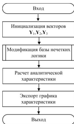
Рисунок 9 – Алгоритм гибридного анализатора сетевого трафика
