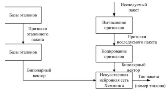
Рисунок 5 – Схема обработки данных в нейросетевом анализаторе Хемминга
