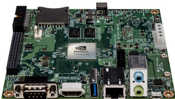
**Рисунок 7 – Вычислительный модуль с интегрированным графическим ядром Nvidia Jetson TK1**
