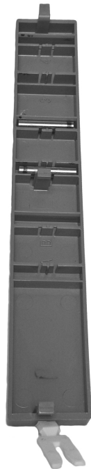
Рисунок 2 – Постоянные магниты, размещенные в корпусе идентификационной метки
