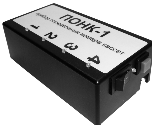
Рисунок 3 – Система автоматизированного контроля идентификационных меток
