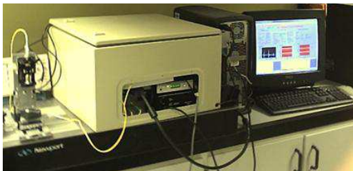
Рисунок 13 – Прибор оптической когерентной томографии (кожный томограф) для исследования поверхностных слоёв кожи и слизистых человека
