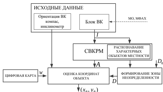
Рисунок 3 – Структурная схема способа видеопозиционирования объектов в городской местности на основе ЦК
