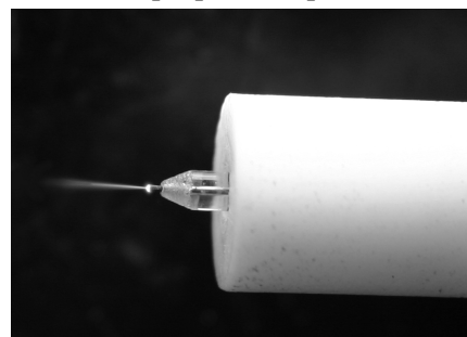
Рисунок 4 – Характерный вид положительного коронного разряда с плазменным столбом (ПС) (фотография получена цифровой камерой)
