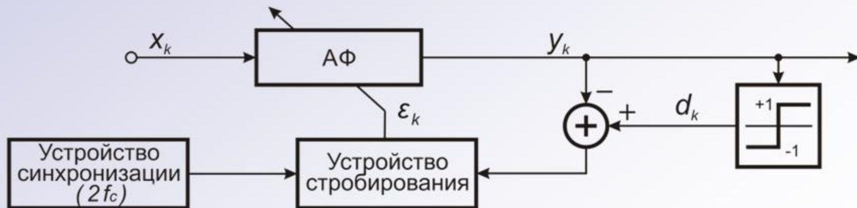
Рис.4.19. Схема адаптивного устройства выравнивания с обучением по решению
