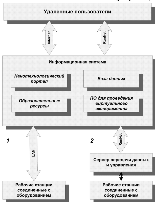
Рисунок 1 – Структура информационной системы для реализации дистанционного эксперимента и обмена научно-техническими и инженерными данными (1 – оборудование расположено в той же организации, что и сервер, поддерживающий информационную систему, 2 – оборудование находится в другой организации)
