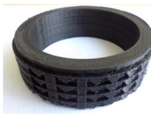
Рисунок 2 – Внешний вид каркаса, изготовленного методом 3D-печати
