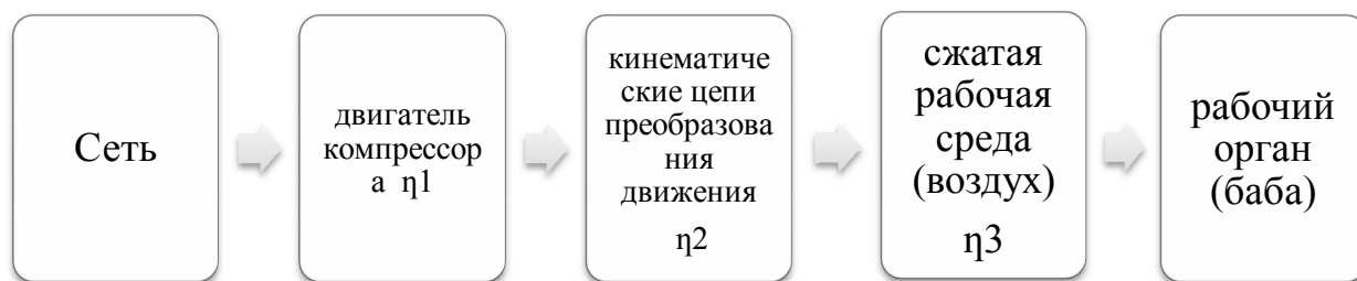
Рис. 1. Диаграмма преобразований энергии в приводном пневматическом молоте
