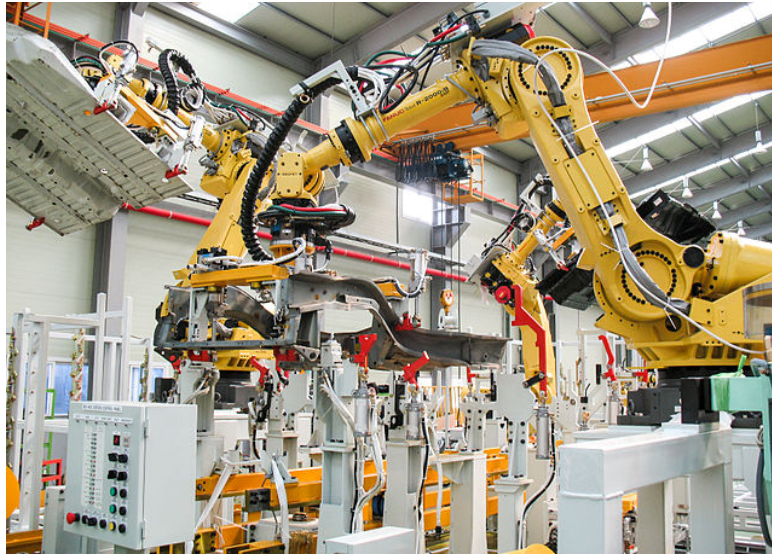
Рис. 1. Пример промышленного робота FANUC R2000iB [1]
