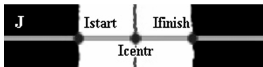
Рис. 1 - Определение точек профиля поковки по краевым точкам на бинаризованном изображении сканирующего лазерного луча
