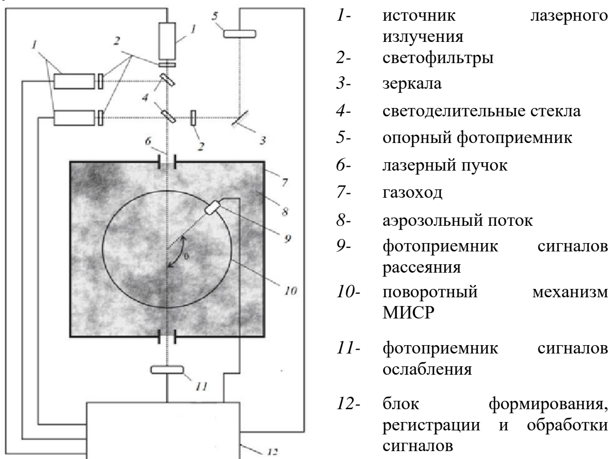
Рисунок 3 - Оптическая схема экспериментальной установки.
