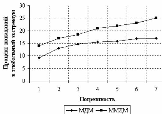
Рисунок 5 - Зависимость вероятности нахождения глобального экстремума от погрешности определения координат в пикселах
