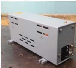
Рисунок 6 – Разработанный малогабаритный стабилизированный He-Ne лазер повышенной когерентности
