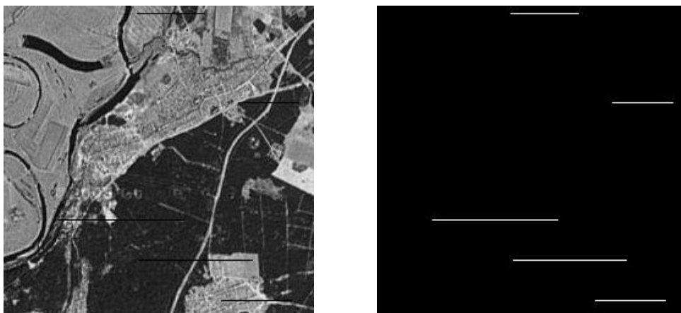
Рисунок 1 – Изображение с искаженной групповой помехой (а) и ее битовая маска (б).
