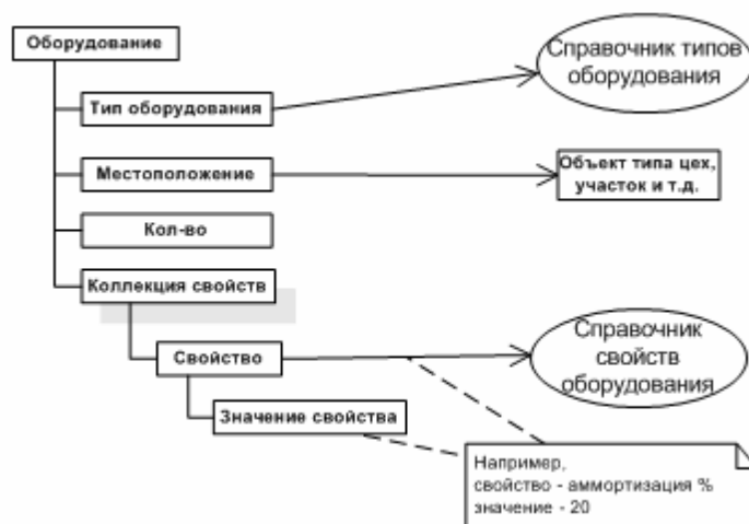
Рисунок 2 Схема структуры класса объекта оборудование
