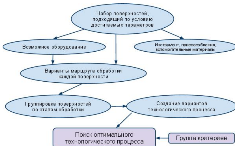
Рисунок 2. Автоматическое формирование технологического процесса.
