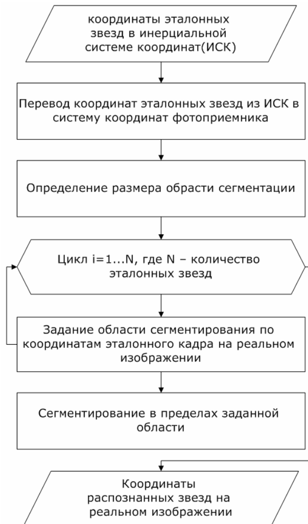
Рисунок 1. Обобщенный алгоритм высокопроизводительной сегментации снимка звездного неба
