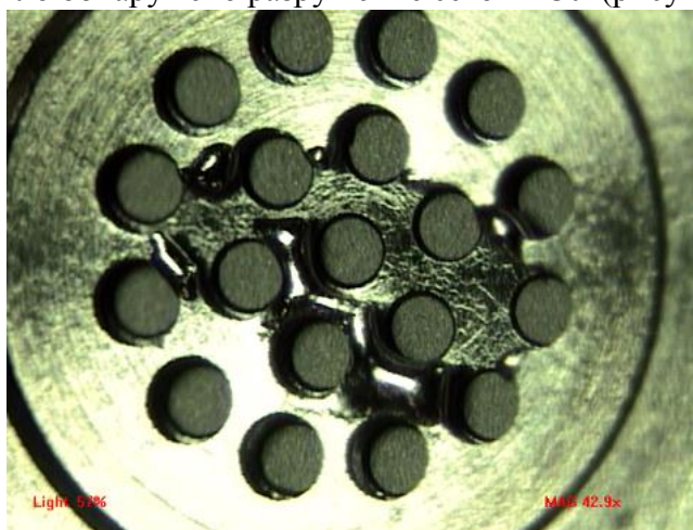
Рисунок 11. Фотография катодно-сеточного узла с теневой и управляющей сеткой из гафния после пробоев.
