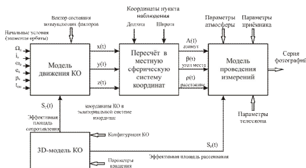
Рисунок 1 – Структурная схема имитационной модели наблюдений за КО
