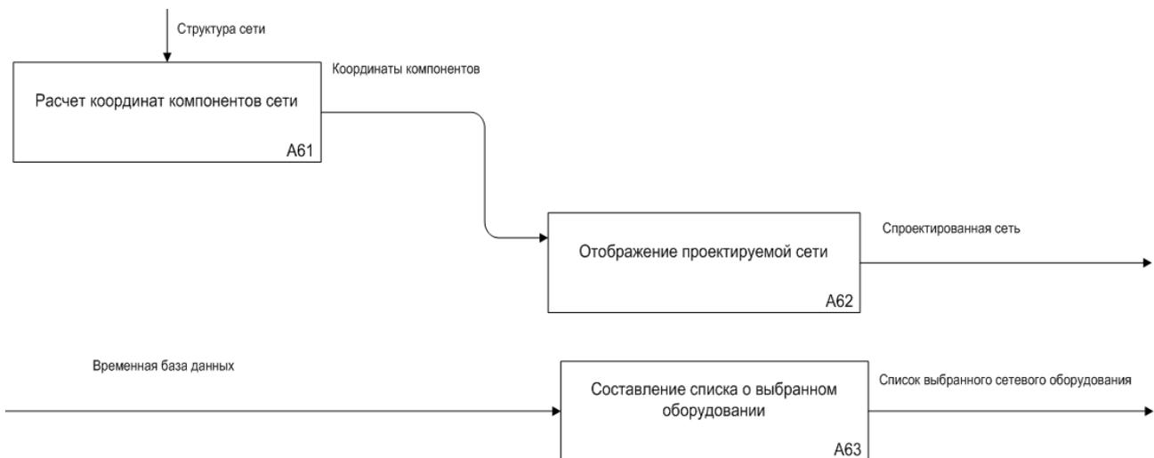
Рис. 5. Декомпозиция блока вывода данных
