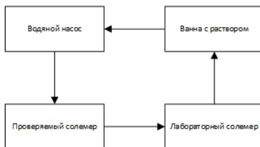
Рис. 1. Схема подключения поверяемого солемера к системе поверки
