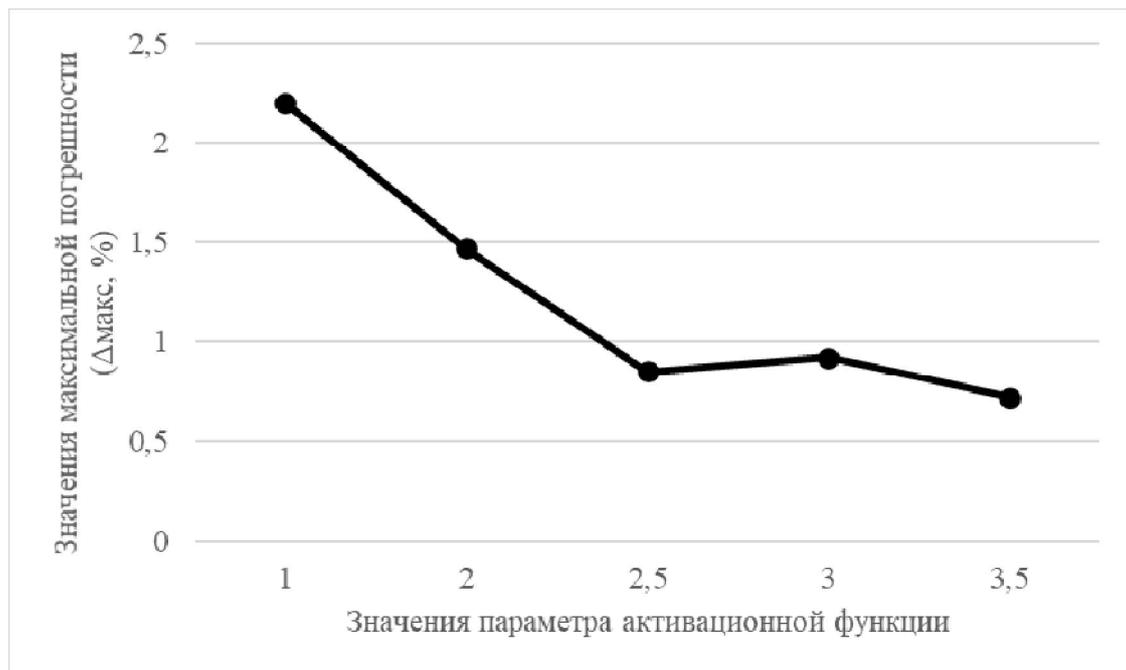
Рис. 5. График зависимости максимальной погрешности преобразования от параметра активационной функции
