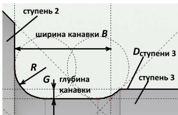
Рис. 4. Параметрические связи при формировании канавки: прямая глубины канавки - D/2 - G * Xp3 * Ap3 ; прямая ширины канавки - L2 + B * Xp3 * Ap3 ; радиусы канавок - R * Xp3 * Ap3 ; Xp3 - лог. переменная чекбокс 3 ступени; Ap3 - лог. переменная чекбокс канавки у третьей ступени
