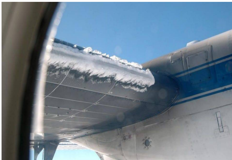
Рис. 3. Рыхлый лёд на крыле самолёта
