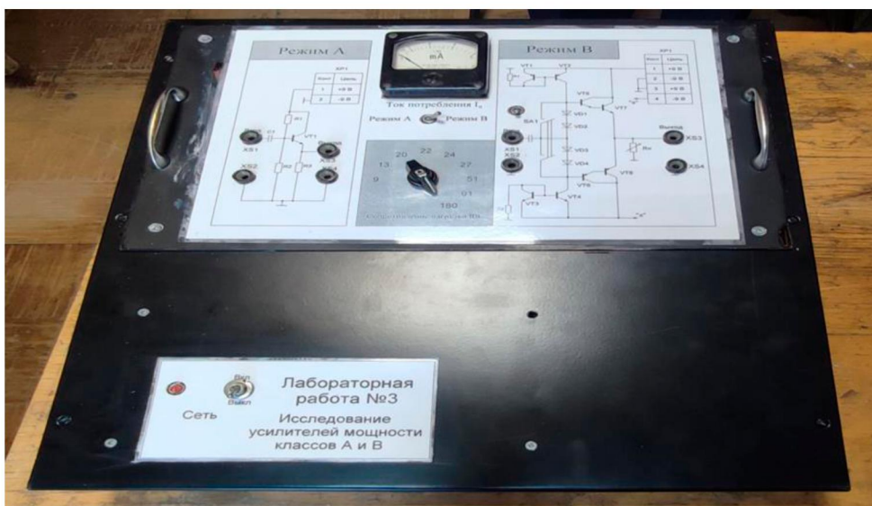
Рисунок 2 - Фотоизображение лабораторного макета
