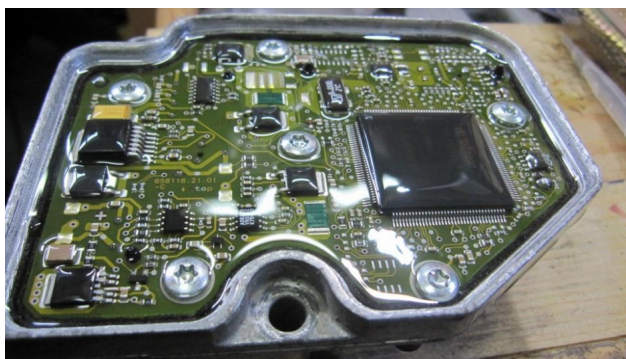
Рисунок 2 – Печатная плата, защищенная слоем силикона
