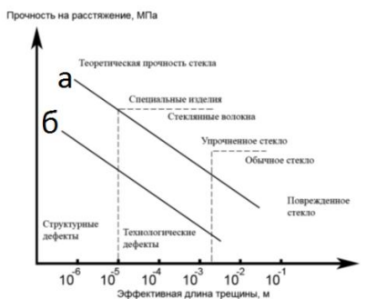
Рисунок 1 – Зависимость прочности стекла на растяжение от размера дефектов (а – быстрая скорость приложения нагрузок; б – долговременная прочность)
