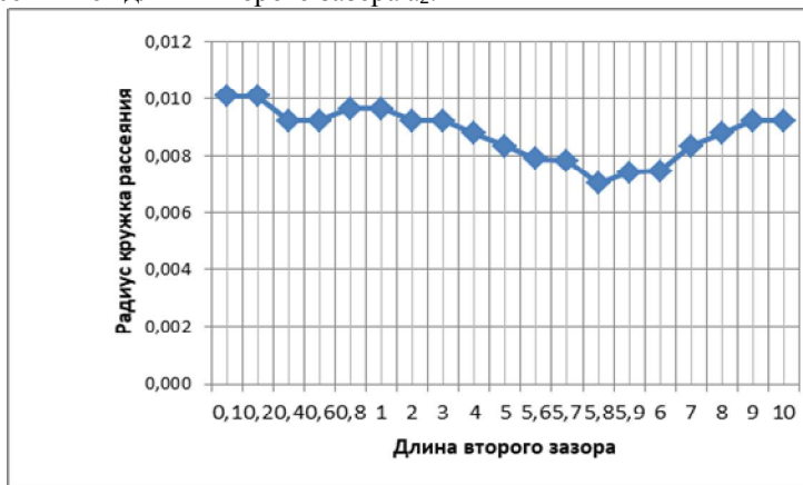
Рисунок 8 – График зависимости радиуса кружка рассеяния от длины второго зазора a_2
