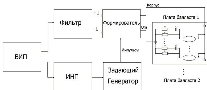
Рисунок 3 – Функциональная схема импульсного генератора: ВИП – высоковольтный источник питания; ИНП – низковольтный источник питания
