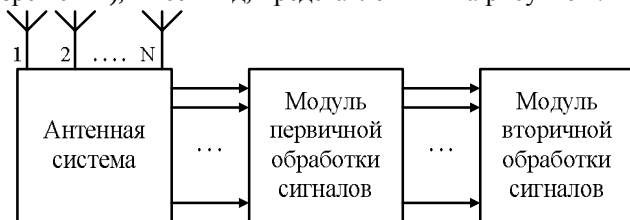
Рисунок 2 – Структурная схема радиопеленгатора
