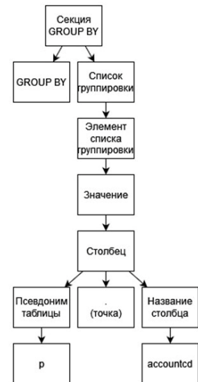
Рис. 4. Синтаксическое дерево секции GROUP BY
