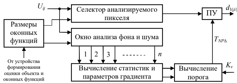
Рис. 3. Обобщенная структурная схема ПУЛТ процессора
