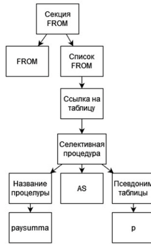
Рис. 3. Синтаксическое дерево секции FROM
