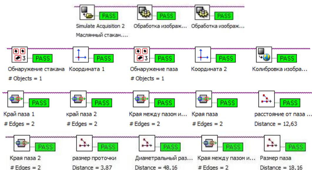
Рис. 3. Алгоритм работы СТЗ для оценки параметров детали
