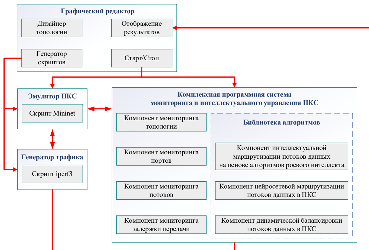
Рисунок 3 – Структура визуальной программной системы интеллектуальной маршрутизации и балансировки потоков данных в ПКС SDNLoadBalancer
