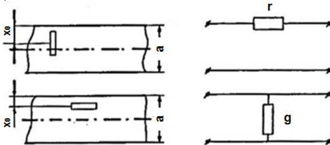
Рис. 3. Эквивалентные схемы щелей в прямоугольном волноводе
