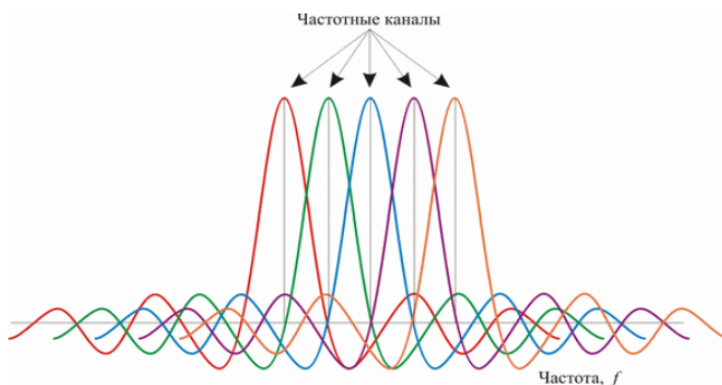
Рис. 2. Расположение частотных каналов сигнала OFDM
