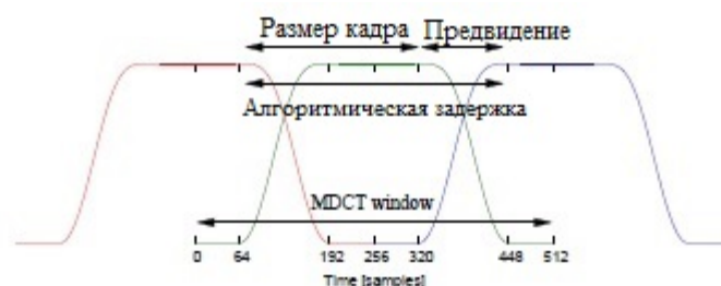
Рис. 1. Мощно-дополняющие окна с уменьшенным перекрытием
