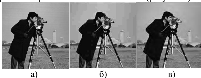
Рисунок 2 – Сравнение артефактов JPEG и JPEG2000 (сжатие в 20 раз)
