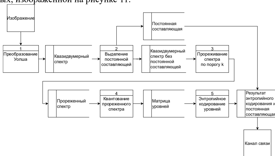
Рисунок 11 – Диаграмма потоков данных предложенного метода сжатия изображения
