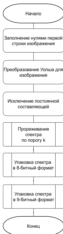
Рисунок 6 – Схема алгоритма сжатия изображения в квазидвумерном спектре с восстановлением постоянной составляющей и устранением высокочастотных составляющих
