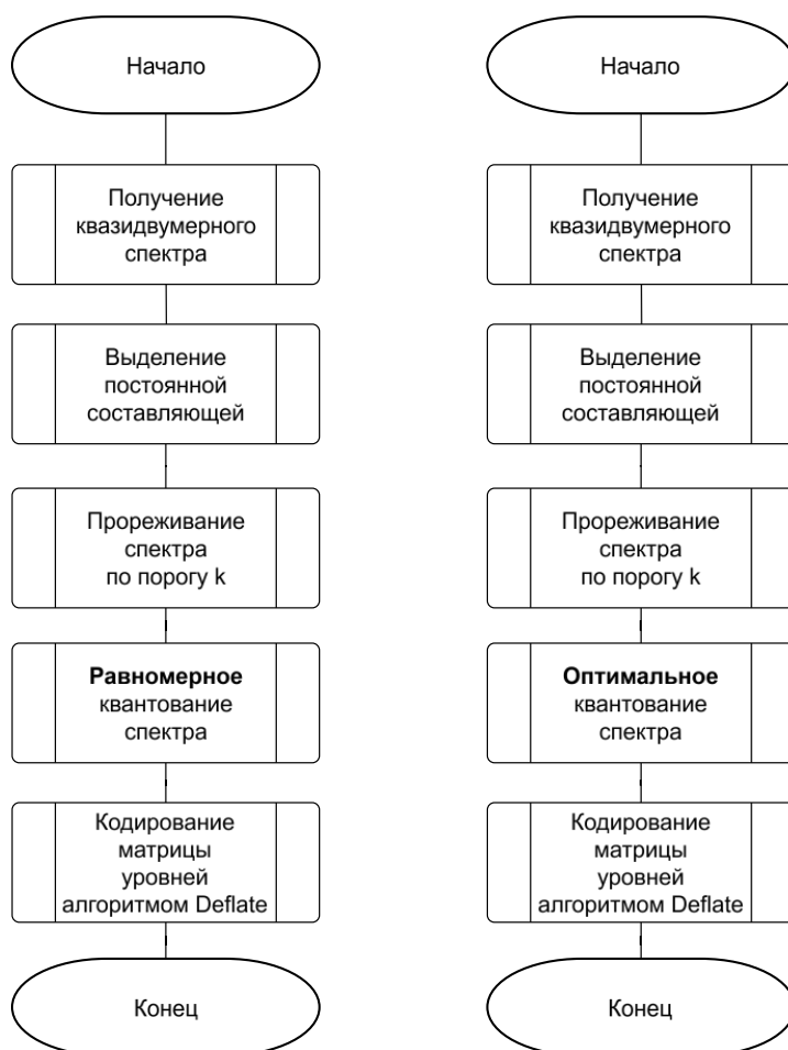
Рисунок 12 – Схемы алгоритмов сжатия изображений в квазидвумерном спектральном пространстве с равномерным и оптимальным квантованием составляющих
