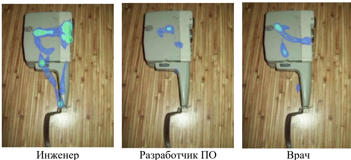
Рис. 5. Типичные тепловые карты зрительной активности профессиональных специалистов с различными навыками при решении задачи распознавания назначения устройства. Устройство «Кинокамера»
