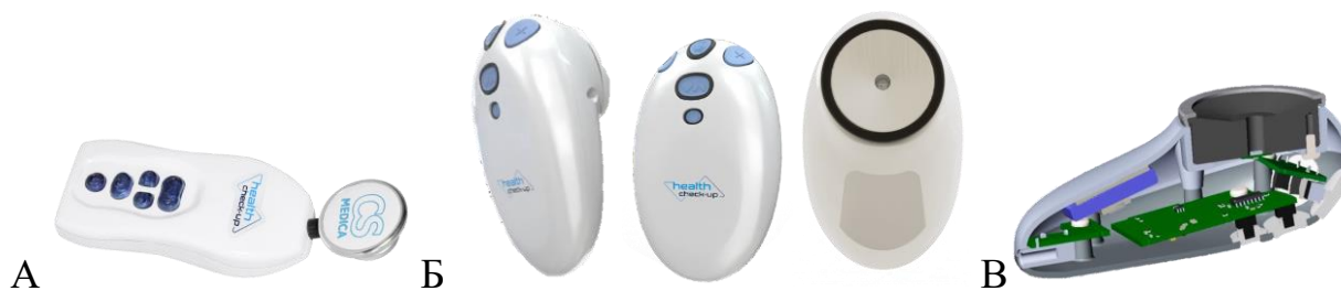
Рис. 9. Цифровой фонендоскоп: А – Прототип №1 с выносной акустической головкой; Б – Прототип №2 с акустической головкой в составе корпуса; В – Прототип №2 в разрезе
