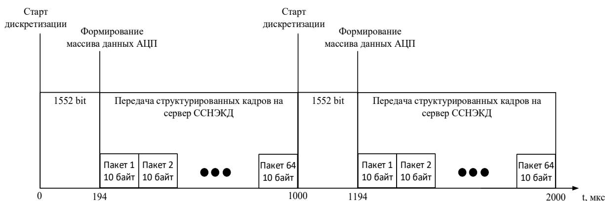
Рисунок 4 – Временная диаграмма формирования массива данных АЦП и передачи структурированных данных на сервер ССНЭКД
