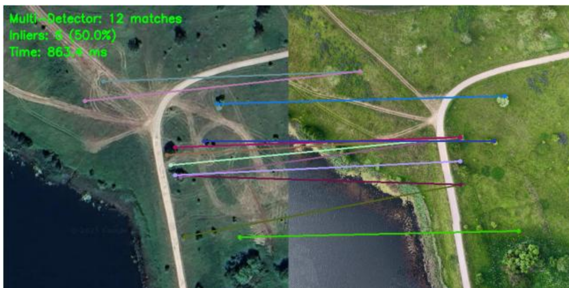
Рисунок 11 – Пример сопоставления ключевых точек для нейросетевого дескриптора Multi-Detector
