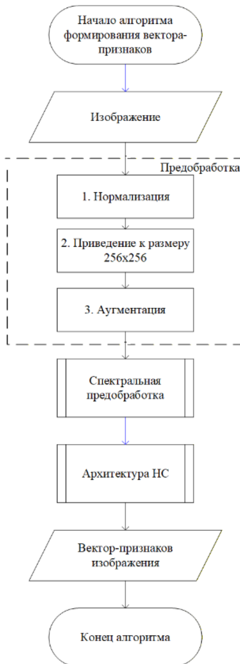
Рисунок 32 – Схема алгоритма формирования вектора-признаков изображения
