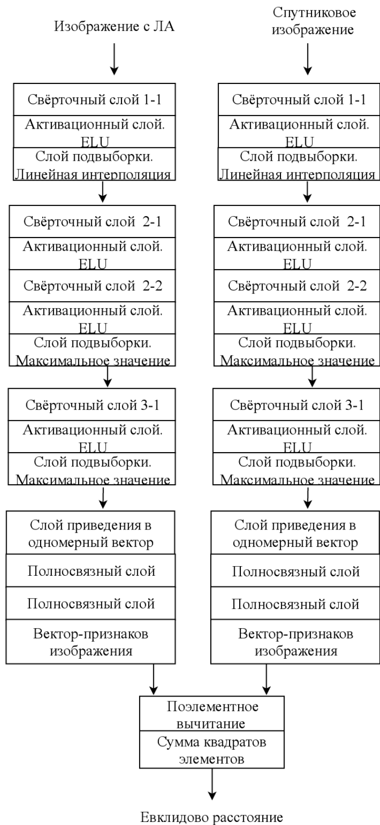
Рисунок 30 – Архитектура сверточной нейронной сети
