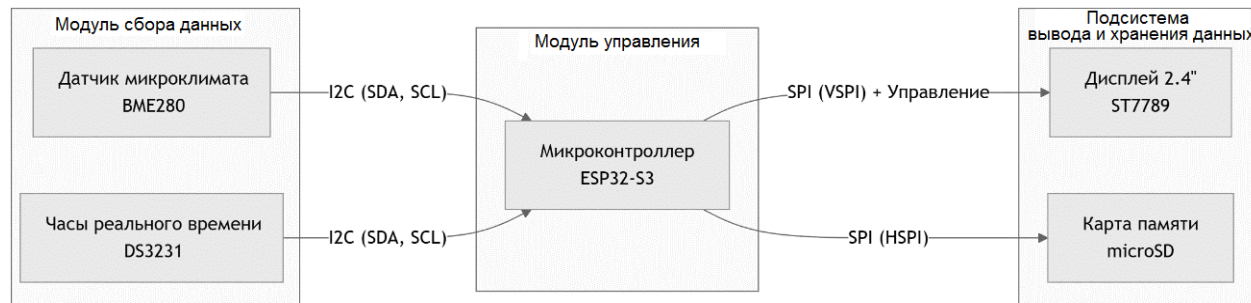
Рис. 1. Структурная схема аппаратной части измерительного стенда
