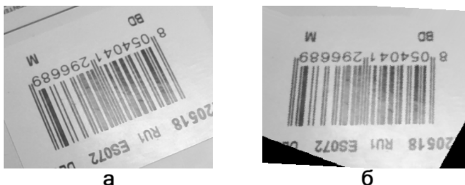
Рис. 10. Сопоставление исходного и скорректированного изображений штрих-кода: а – исходное изображение с искажениями, б – результат после выполнения всех описанных этапов коррекции
