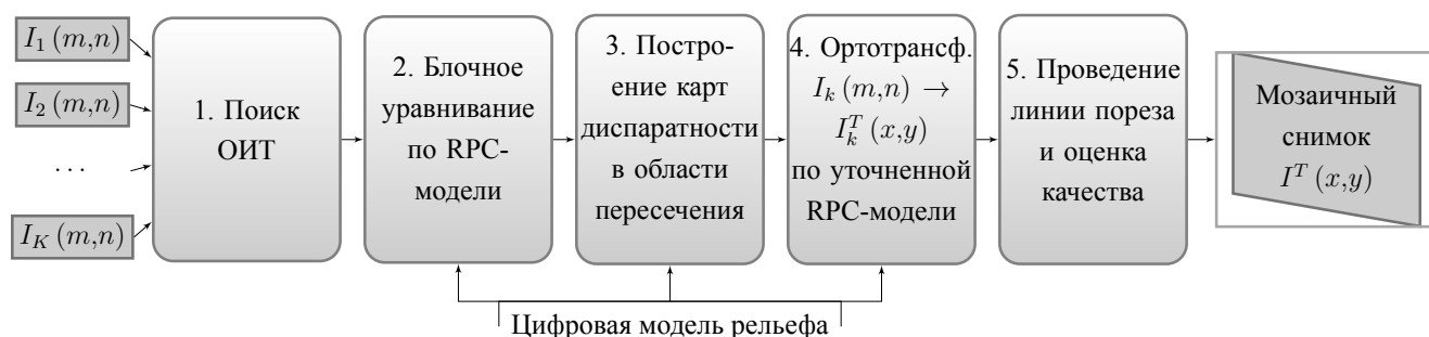
Рисунок 3.1 — Технологическая схема синтеза непрерывного мозаичного снимка по данным площадной съёмки
