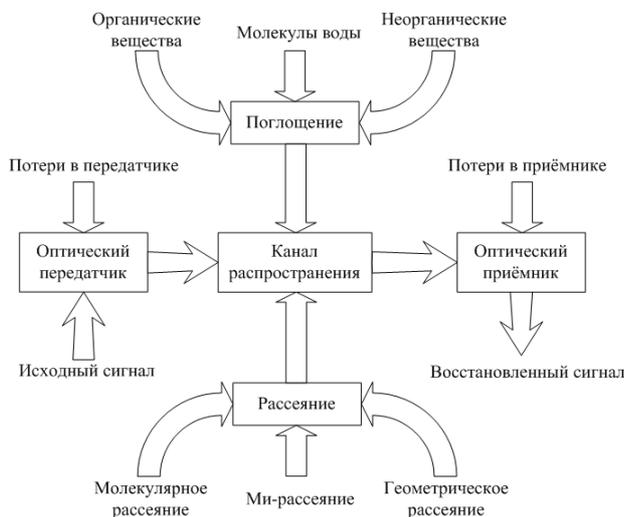
Рисунок 1 – Схема распространения оптического сигнала в водной среде
