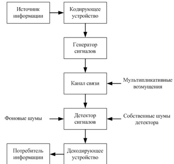
**Рисунок 5 - Статистическая модель оптической системы передачи информации**
