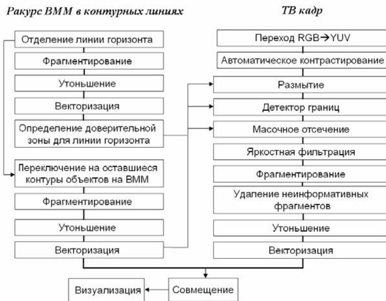
Рисунок 3 – Технология предварительной обработки изображений
