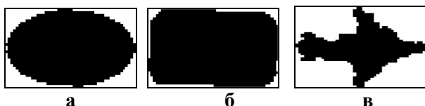
Рисунок 6 – Образцы корабля (а) автомобиля (б), самолета (в), используемые для создания базы данных эталонов
