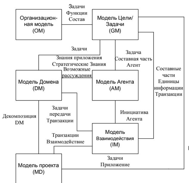
Для упрощения анализа мультиагентной информационно-измерительной системы технического контроля и диагностики определены субмодели, которые отражают различные её аспекты. Данный набор субмоделей представлен на рисунке 2:
