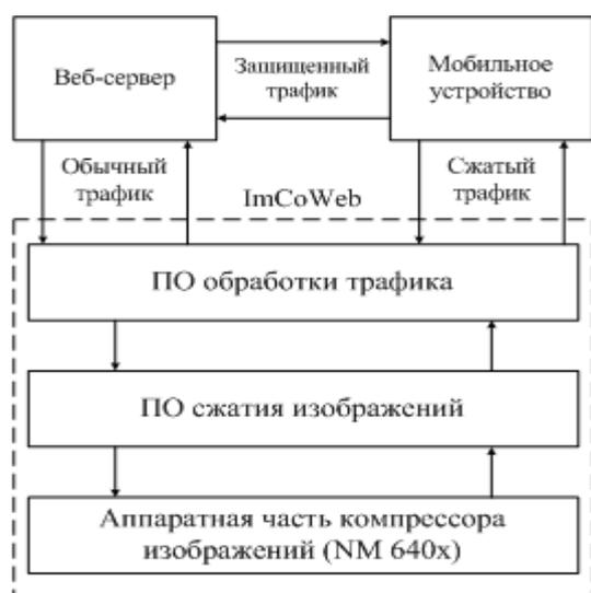
Структурная схема комплекса ImCoWeb
