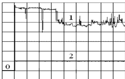
Рисунок 4 – Осциллограммы напряжения на замкнутых контактах разгерметизированного геркона после включения тока 50 мА (1) и через несколько секунд его пропуска (2).
