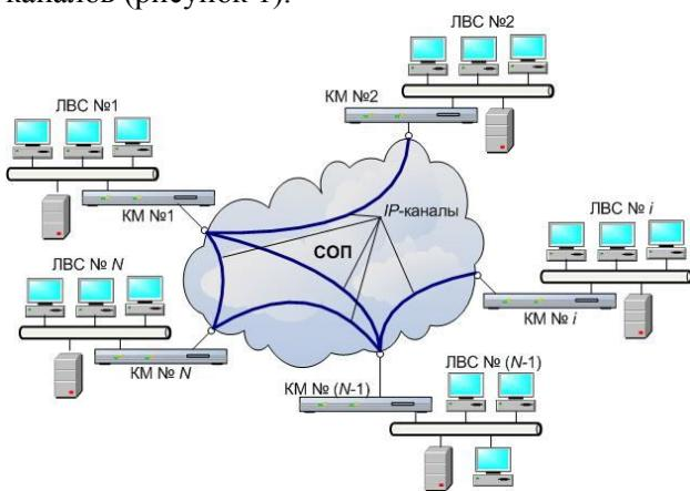
Рисунок 1 – Структура VPN-сети (вариант)
