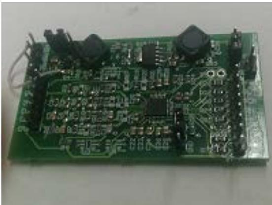
Рис. 2. Отладочная плата на базе AFE ADS1292R
