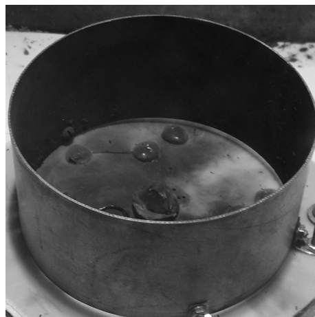
Рисунок 2 – Прочная тонкая плёнка на текстолитовом основании после электрического взрыва спиралей
