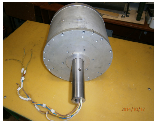
Рисунок 4 – Внешний вид генератора мощностью 800 Вт и скоростью вращения 240 об/мин
